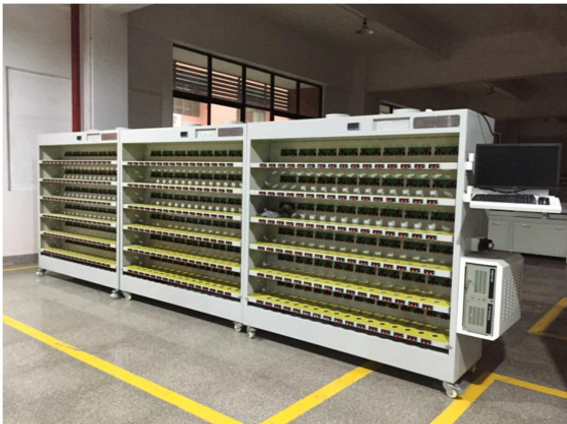
LEDRACK-100W192P LED 驱动老化架适用于 LED 驱动成品产线测试，依据 IEC62384:2011 和 GB/T 24825-2009 标准设计。
